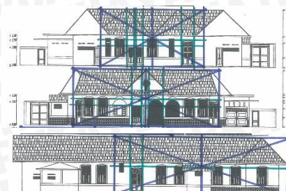
Gambar 4.610. Proporsi pintu tampak rumah dinas nomor 37 & 39
