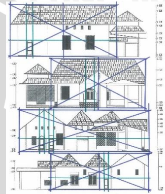
Gambar 4.607. Proporsi pintu tampak rumah dinas nomor 6 & 8
