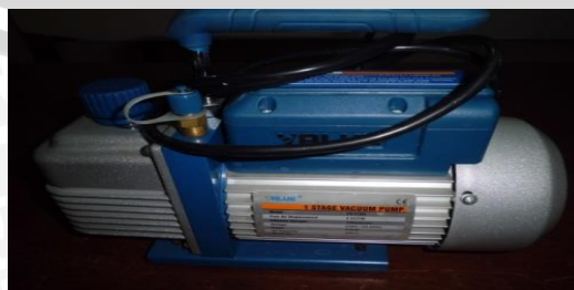
Gambar 3.15 Mesin vakum refrigeran Sumber : Arsip pribadi
