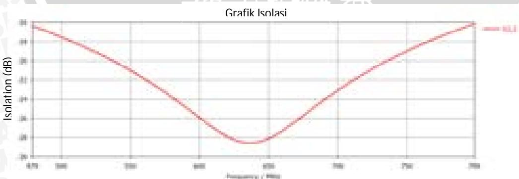
**Grafik 4.4** Hasil Simulasi Isolasi *Port Output Power Divider* (Setelah Optimasi)
