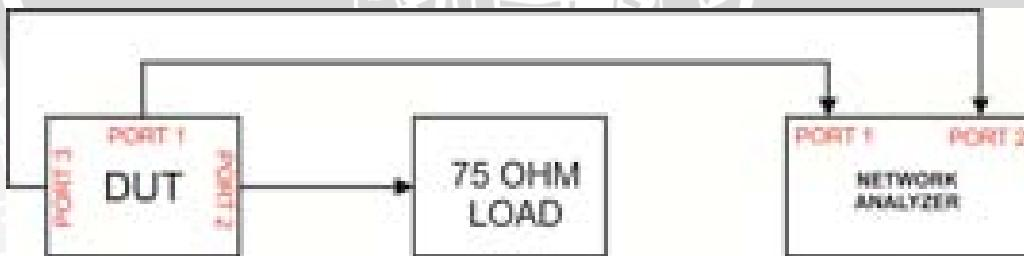
Gambar 5.6 Blok Diagram Pengukuran *Insertion Loss* antara *Port 1* dan *Port 3*
