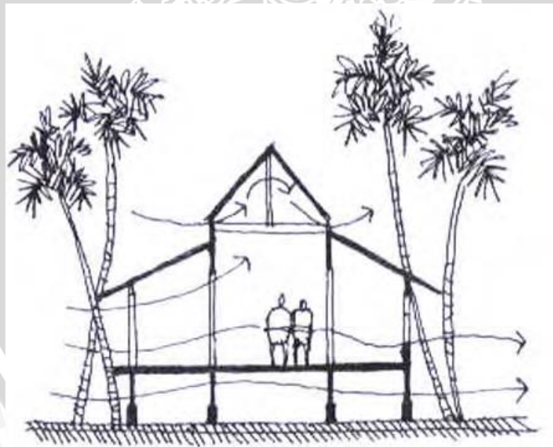
Gambar 2.5 Cross Ventilation pada bangunan panggung Sumber : Heinz Frick, Arsitektur Ekologis (2006)
