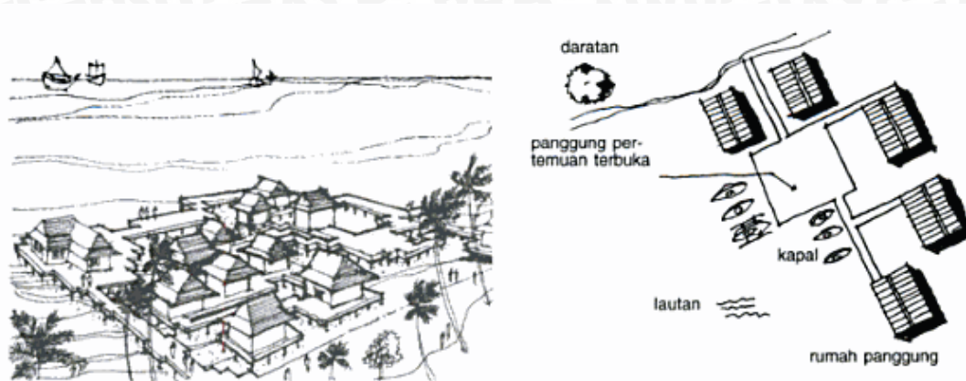
Gambar 2.3 Bangunan panggung dengan sirkulasi jembatan penghubung Sumber : Heinz Frick, 2006, Seri Eko-Arsitektur 2 "Arsitektur Ekologis".
