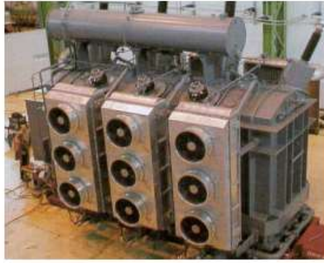
Gambar 2. 7 Pendingin Paksa untuk Transformator Sumber : PT PLN (Persero) P3B, 2003; 26
