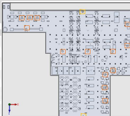
Gambar 4.31 Letak Air Conditioner Rekomendasi Perbaikan 2
