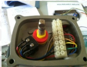
Gambar 4.16 Pengkabelan Sensor Limit Switch (Sumber: Perancangan, 2014)
