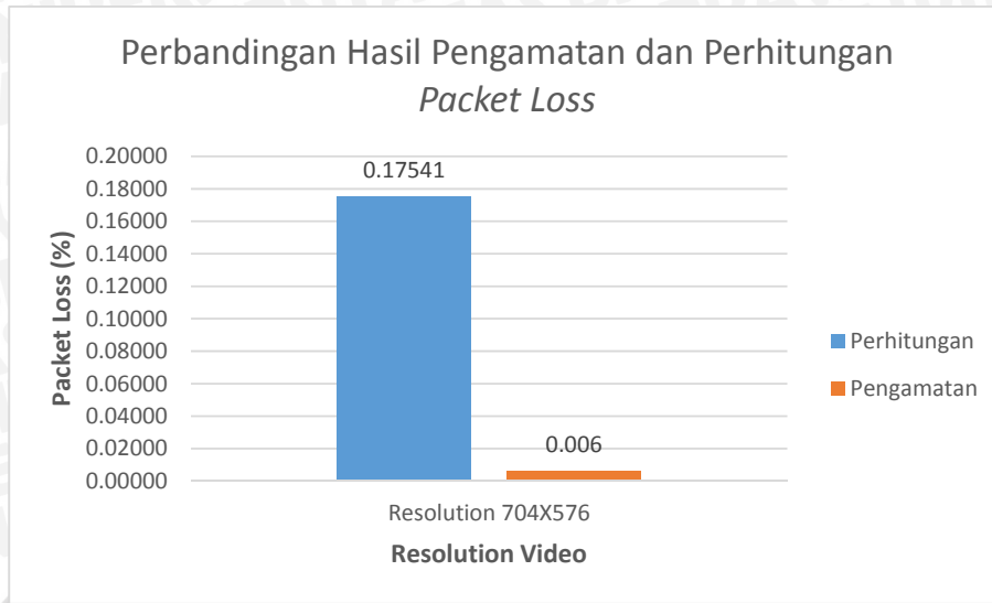
Gambar 4.23 Tampilan Perbandingan Hasil Pengamatan dan Perhitungan Packet Loss
