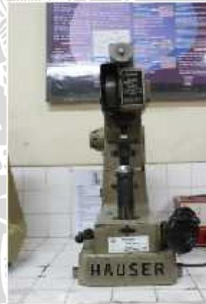
Gambar 2.18 : Pengujian Brinell
