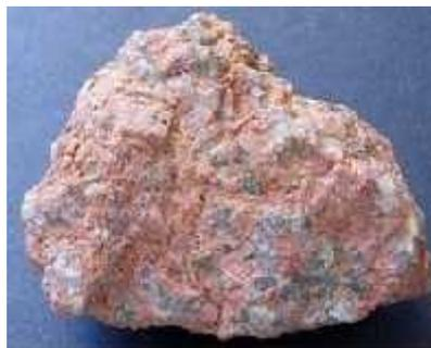
Gambar 2.9 : Feldspar dalam bentuk Gumpalan
