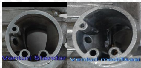
Gambar 2.7 Diameter venturi standar dan diameter venturi modifikasi Sumber : Suherman & Sriyono (2010:12)
