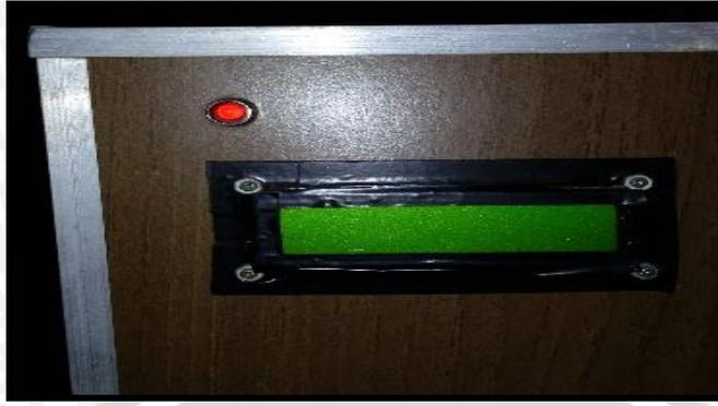
Gambar LCD 16x2
