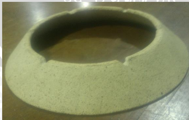
Gambar 3.11 Selubung dengan material keramik
