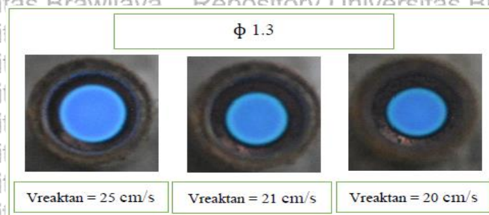
Gambar 4.4. Visualisasi bentuk nyala api pada meso-scale combustor dengan backward facing step , D_1/D_2 = 2.6/3.5 pada nilai rasio ekuivalen 1,3 dengan kecepatan reaktan 25 cm/s, 21 cm/s dan 20 cm/s
