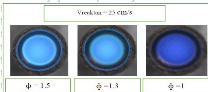
Gambar 4.5 Visualisasi bentuk nyala api pada meso-scale combustor dengan backward facing step , D_1/D_2 = 3.5/4.7 pada kecepatan reaktan 25 cm/s dengan nilai rasio ekuivalen 1.5, 1.3 dan 1
