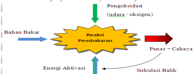
Gambar 2.3 Ilustrasi proses pembakaran Sumber : (Wardana, 2008)
