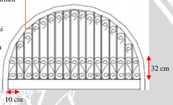
Gambar 4.87. Detail ornamen A jalusi ventilasi pada jenis jendela 2
