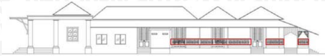
Gambar 2.24 Balustrade pada bangunan rumah dinas Bakorwil Kota Madiun. Sumber : Sukarno (2014:45)
