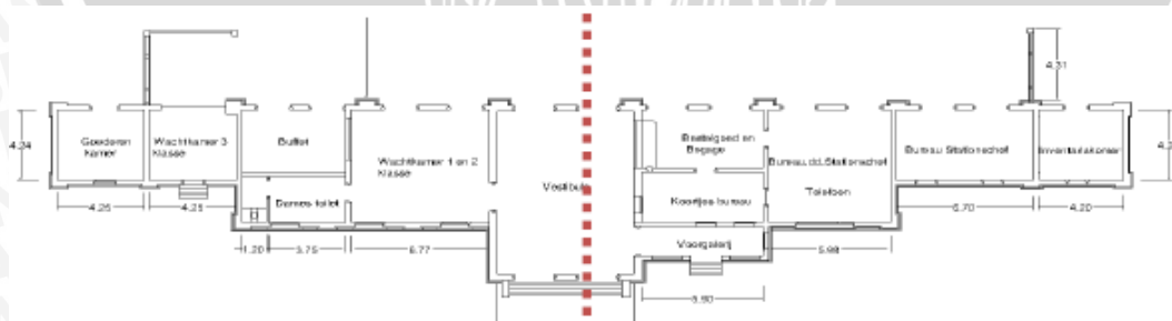
Gambar 2.17 Simetri pada bangunan stasiun Bondowoso.
