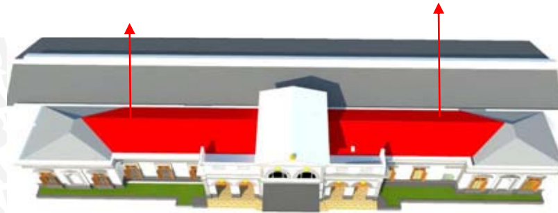
Gambar 4.36. Atap pelana pada bangunan Stasiun Solo Jebres
