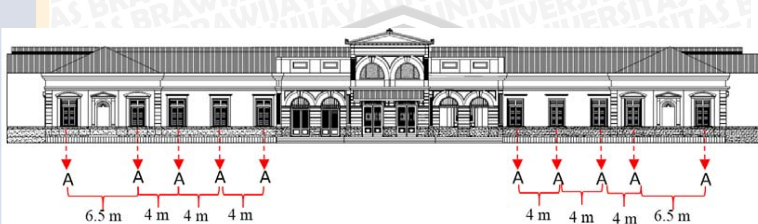
Gambar 4.100. Perulangan bentuk jendela pada fasade utara bangunan stasiun Solo Jebres
