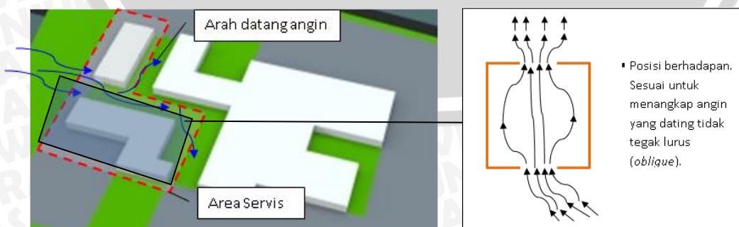
Gambar 4.45 Konsep penghawaan dengan bukaan berhadapan
