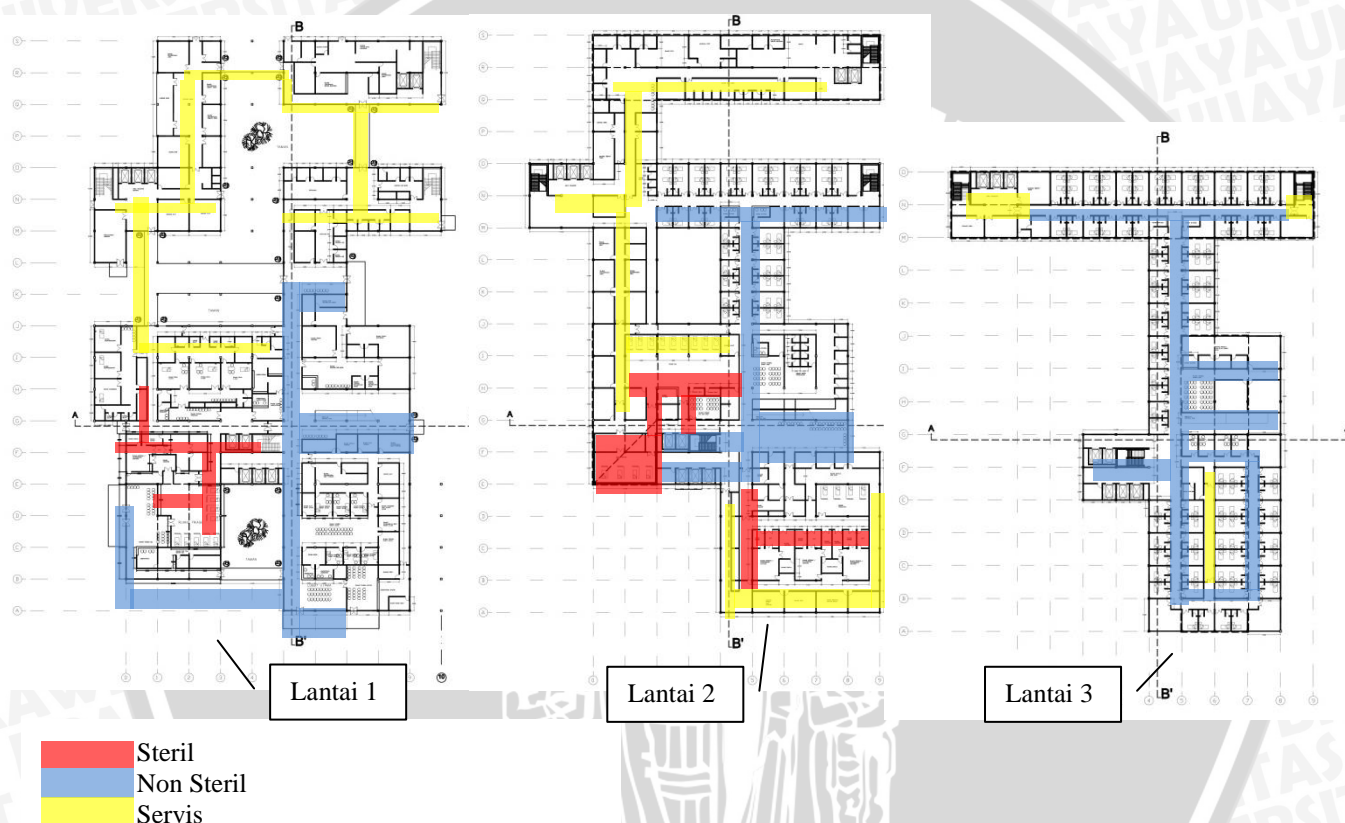
Gambar 4.70 Letak area steril, non-steril, dan servis
