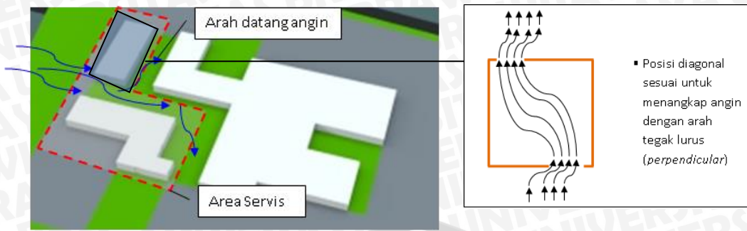
Gambar 4.46 Konsep penghawaan dengan bukaan diagonal
