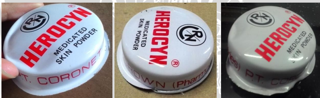
Gambar 4.9 Jenis Cacat Curling pada Komponen Cover
