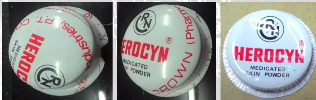
Gambar 4.8 Jenis Cacat Stamping pada Komponen Cover
