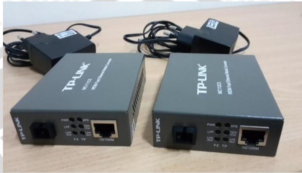
Gambar 4.4 Media Converter TP LINK MC111CS dan TP LINK MC112CS (Sumber: Perancangan)
