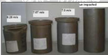
Gambar 2.1 Hasil Pengujian Dinamik Terhadap *Crash Box* Berpenampang Lingkaran
