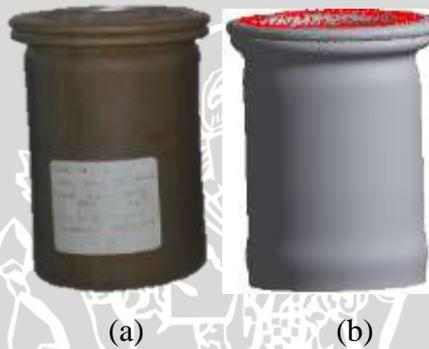
Gambar 4.1 Validasi *Crash Box* Hasil (a) Eksperimental, (b) Simulasi
