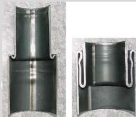
Gambar 2.6 *Hydroformed Bumper Stay* Setelah Diuji
