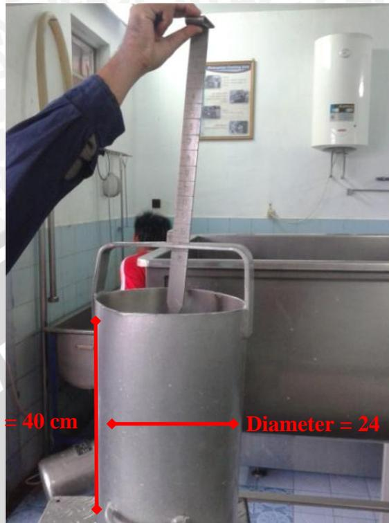
Gambar 4.2 Tabung Pengukur Volume Mekanik
