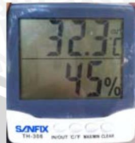
**Gambar 3.5** Alat pengukur temperatur dan kelembapan (*Thermometer*).
