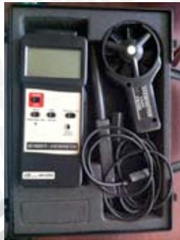
**Gambar 3.4** Alat pengukur kecepatan angin (*Anemometer*)
