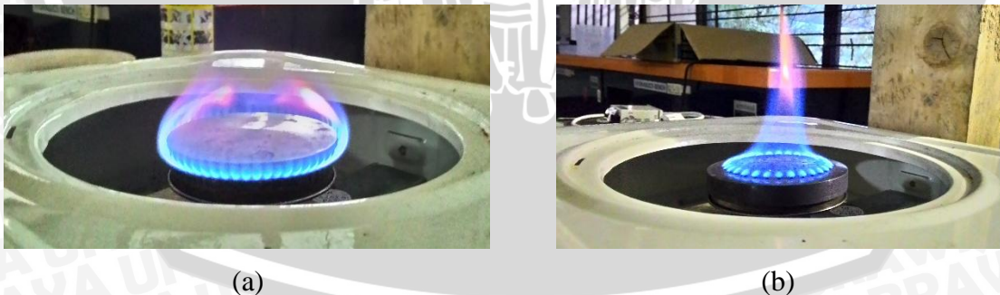
Gambar 4.2 Perbedaan nyala api antara (a) burner biasa dengan (b) perforated burner Sumber: Arsip Pribadi
