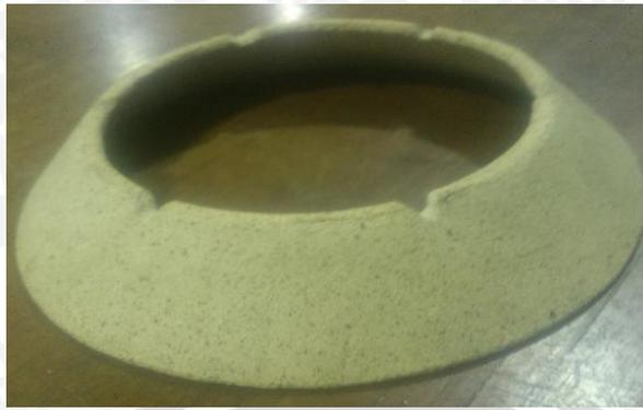
Gambar 3.8 Selubung dengan material keramik
