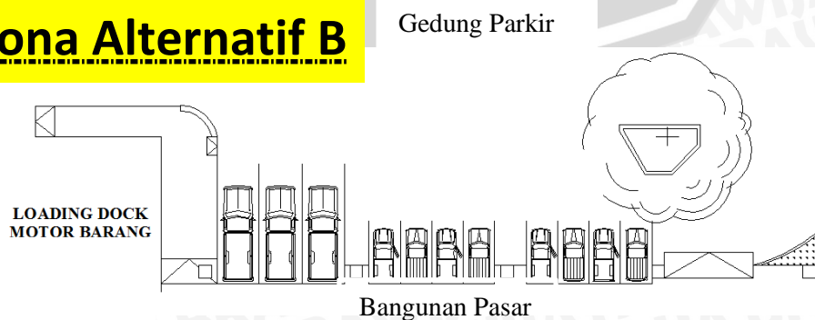
Gambar 4.63 Alternatif Sistem Loading Dock
