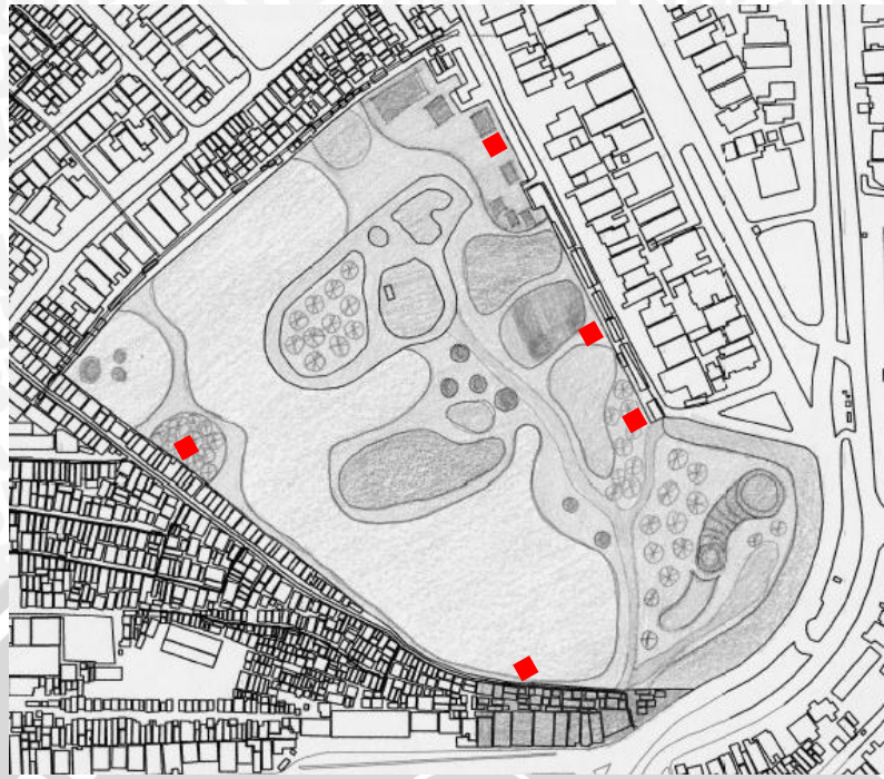
Gambar 4.64 Konsep peletakan pompa air tenaga surya dan tangki air
