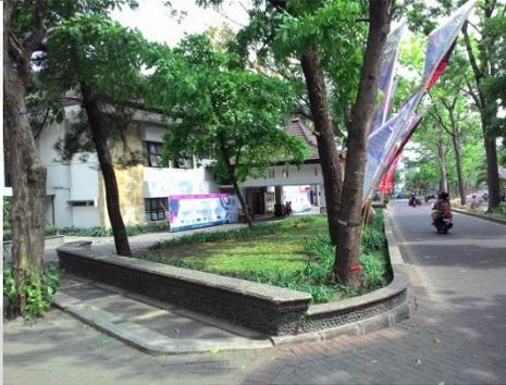
Jalur pejalan kaki dibedakan dengan jalur kendaraan dengan ketinggian 5 cm, dan perkerasan permukaan yang berbeda. Jalur pejalana kaki dengan perkerasan batu ampyang dan perkerasan paving untuk jalur kendaraan.
