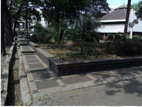
Jalur pejalan kaki dan kendaraan telah terpisah oleh ketinggian dan perbedaan perkerasan setiap jalurnya. Perkerasan paving untuk jalur kendaraan dan perkerasan batu ampyang untuk jalur pejalan kaki.
