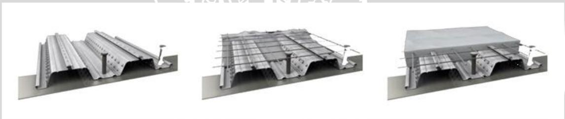
Gambar 4.99 pemasangan *Floor deck system* menggunakan tulangan susut
