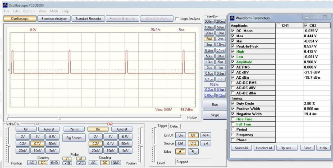
**Gambar 5.2 Sinyal Kontrol dengan Parameter Motor Servo Sudut  $0^\circ$**
