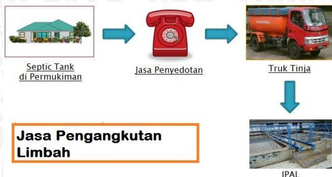
**Gambar 4. 11 Diagram Proses Pengangkutan Air Limbah**
