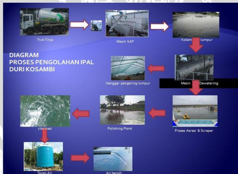
Gambar 4.10 Diagram Proses Pengolahan Limbah Teknologi Baru (2012)
