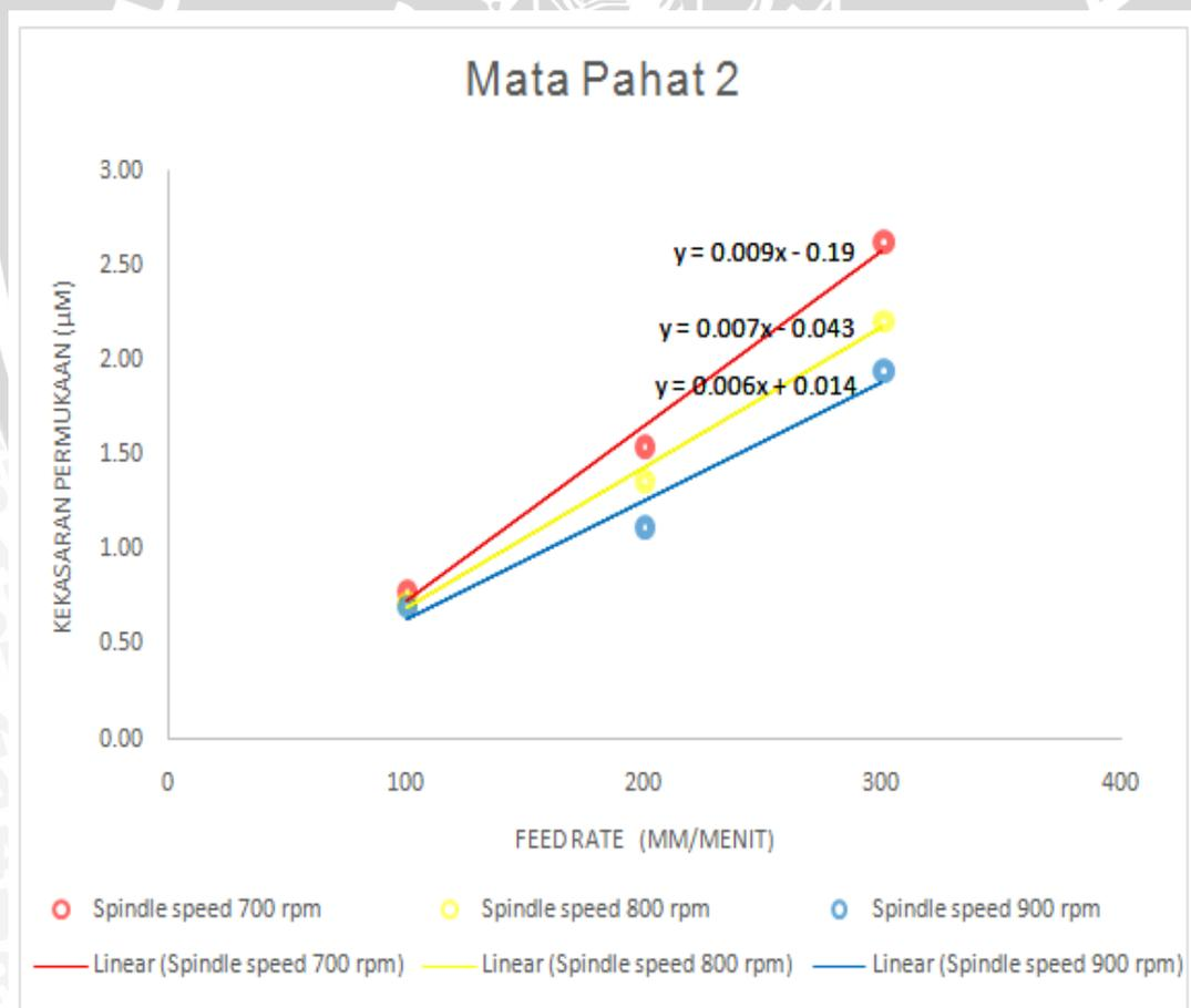
Gambar 4.1 Grafik Hubungan antara *Feed Rate* dan *Spindle Speed* terhadap Kekasaran Permukaan dengan *Ball Nose End Mill* Mata 2
