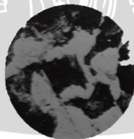
Gambar 2.12 Struktur medium-carbon-steel . Pembesaran x 200 Sumber : Mohinder L. Nayar (2000:52)
