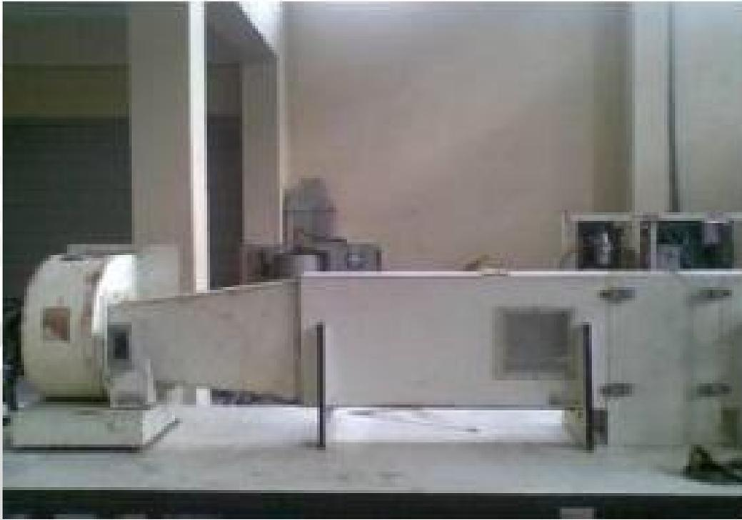
Gambar 3.2 *Wind tunnel*
