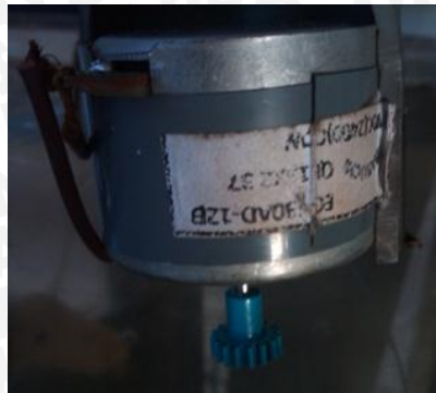
Gambar 3.9 Generator Listrik Sumber: Laboratorium Fluida Universitas Brawijaya
