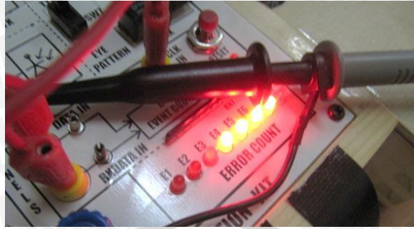
Gambar 4.18. Nyala LED Pada Error Count
