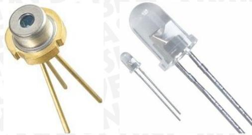
Gambar 2.11. *Laser Diode* dan *Light Emitting Diode*
