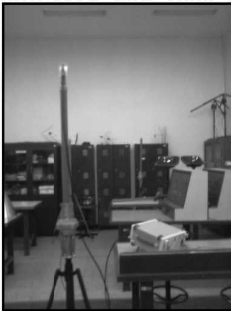
Gambar 7 Pengukuran daya yang diterima antenna referensi untuk pengujian gain
