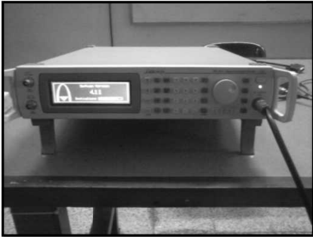
Gambar 5 Signal generator sebagai transmitter untuk pengujian medan jauh antena
