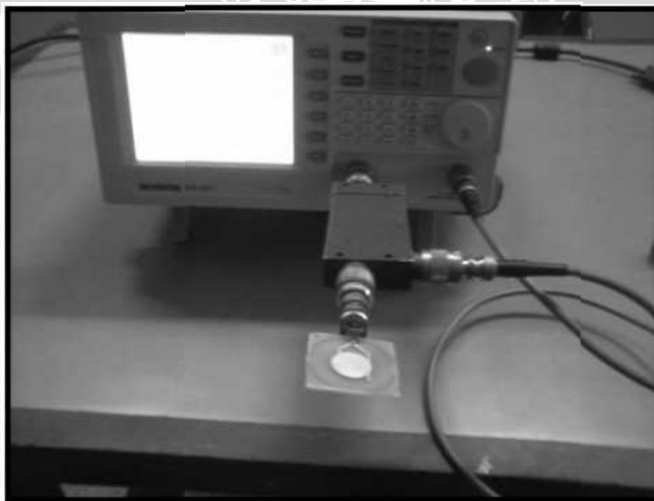
Gambar 2 Pengujian S_{11} antenna menggunakan spectrum analyzer dan directional coupler
