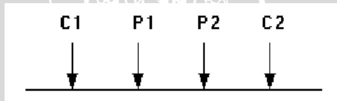
Gambar 2.4 Susunan sederhana 4 konduktor untuk mengukur tahanan jenis bawah permukaan
