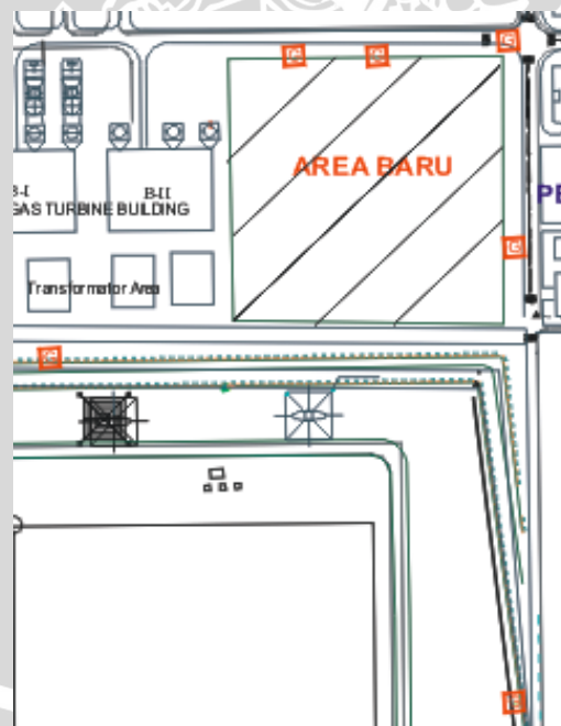
Gambar 4.4 Distribusi titik ukur geolistrik tahanan jenis tanah
