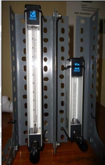
Gambar 3.5 *Flow meter* udara dan bahan bakar
