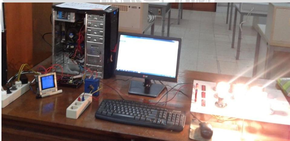
Gambar 4. 2 Rangkaian Pengujian Pengukuran Beban Lampu Pijar
