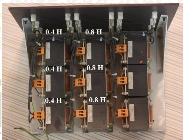
Gambar 4. 13 Induktor di Laboratorium Sistem Daya Elektrik
