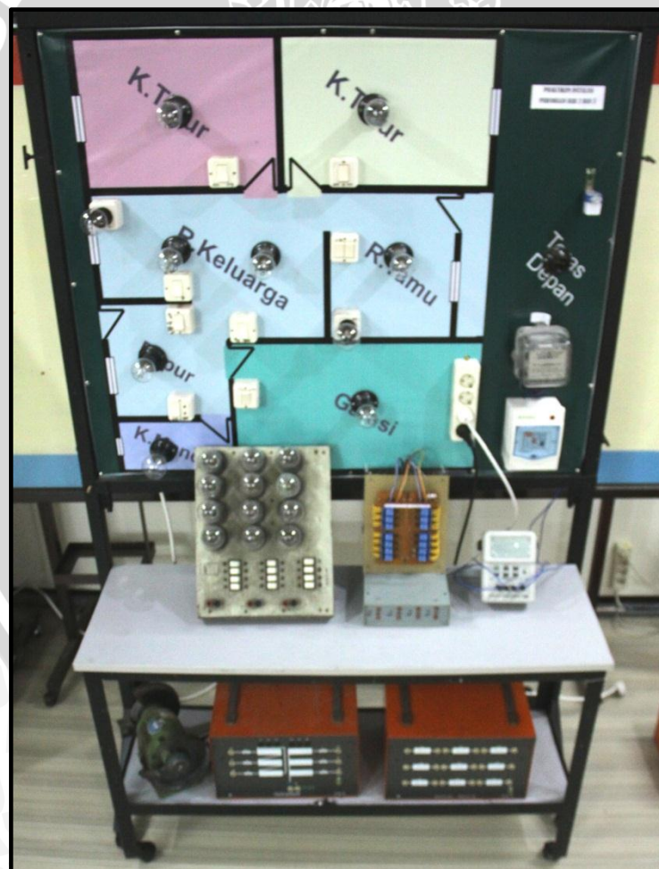
Pengujian sistem kelistrikan rumah tangga dengan menggunakan alat perbaikan faktor daya
