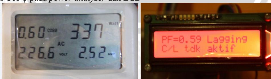
Gambar 5. 25 Pembacaan \cos \phi pada power analyzer dan LCD pada pengujian ke-4
