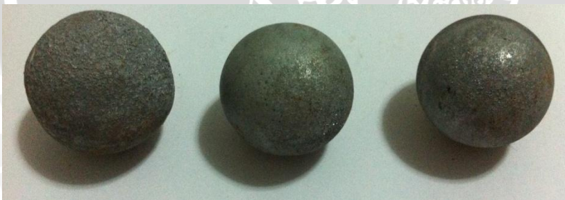
Hasil elektroplating seng selama 45 menit
