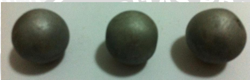
Hasil elektroplating seng selama 30 menit
