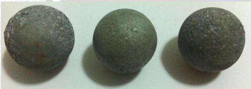
Hasil elektroplating seng selama 60 menit
