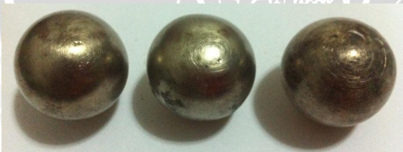
Hasil elektroplating nikel selama 45 menit
