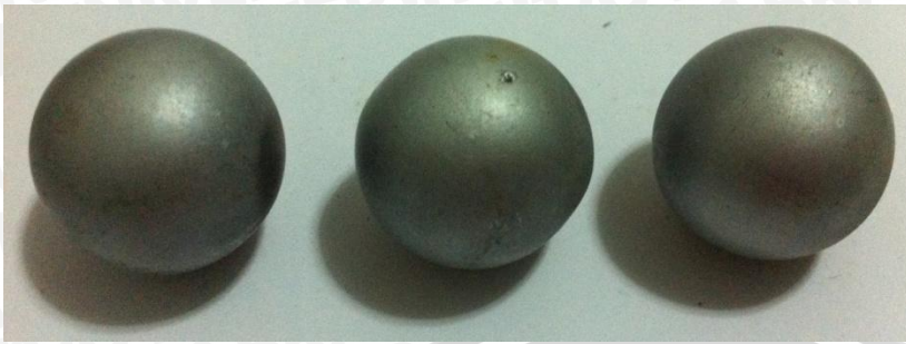
Hasil elektroplating seng selama 15 menit
