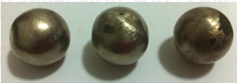
Hasil elektroplating nikel selama 15 menit
