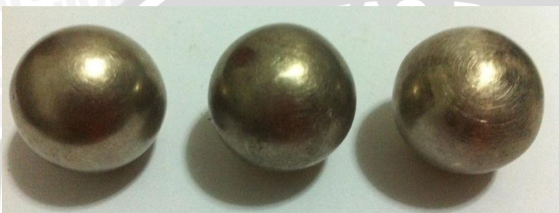
Hasil elektroplating nikel selama 30 menit
