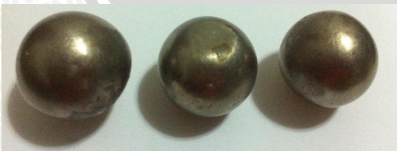
Hasil elektroplating nikel selama 60 menit
