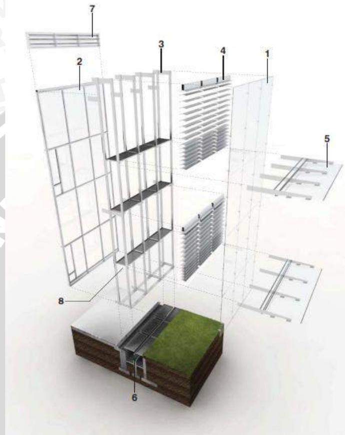
Gambar 2.135 Ilustrasi komponen pada *secondary skin* dengan material kaca
