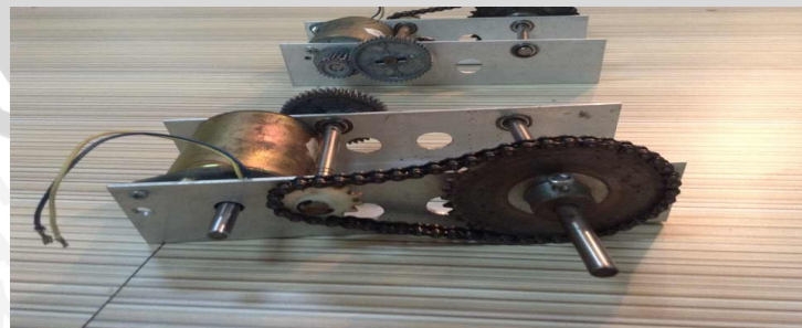
Gambar 4.5 Motor DC dan Rangkaian Gear box ( Sumber: Perancangan)
