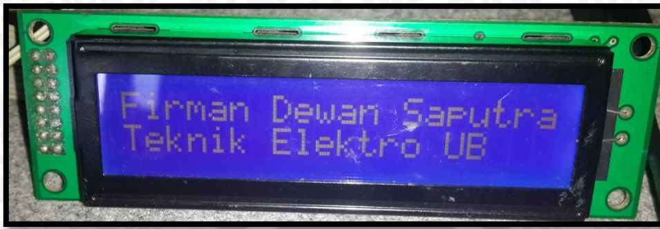
Gambar 5.5 Tampilan Data Karakter Pada LCD
