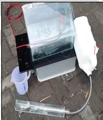
Rumah evaporator, kondensor dan penampungan hasil
