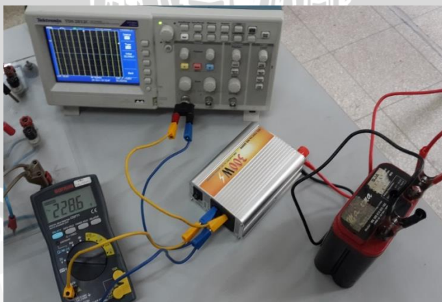
Gambar 5. 20 Gambar Pengujian Rangkaian Inverter
