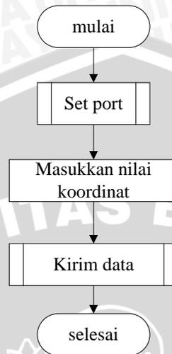
Gambar 4.15 Diagram alir antarmuka pada PC
