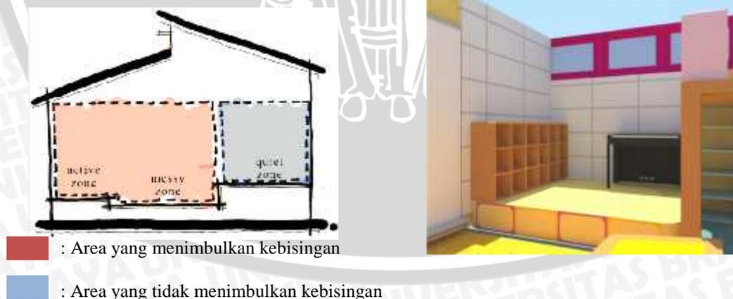
Gambar 4.109. Skema Peletakan Panel Akustik dan Perbedaan Ketinggian
