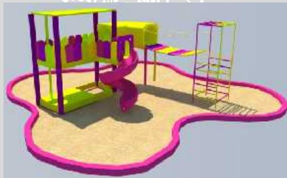
Gambar 4.45. Peletakan Material *Shock-absorbing* Di Bawah Permainan
