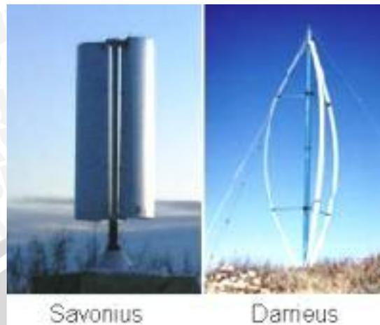
Gambar 2.7 : Turbin angin sumbu vertikal
