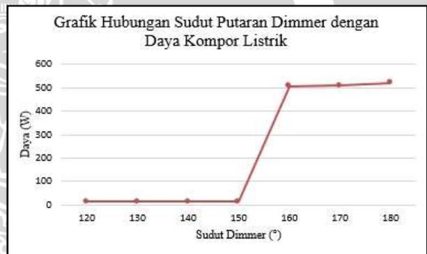
Gambar 10. Grafik Hubungan Sudut Putaran Dimmer dengan Daya Kompor Listrik
