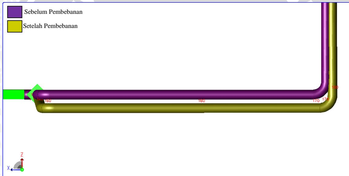
Gambar 4.2 Skema Hasil Simulasi Ekspansi Pipa dengan Menggunakan *Software*
